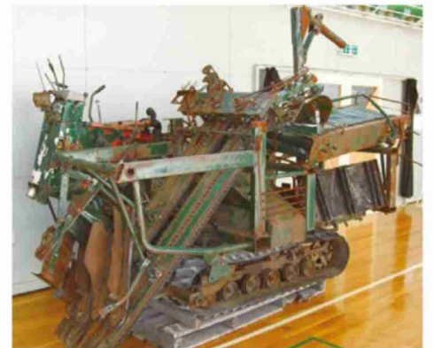
農家の父が農機を自分で直す姿を幼いころから見て育ち、自身も機械いじりが好きだった少年が後に作り上げた自走式の人参収穫機のプロトタイプ。
